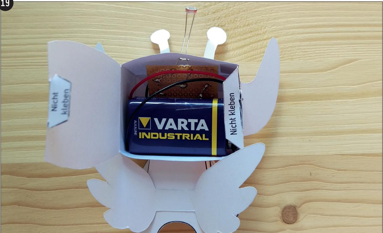
Batterie anschließen und hinter die Platine schieben
